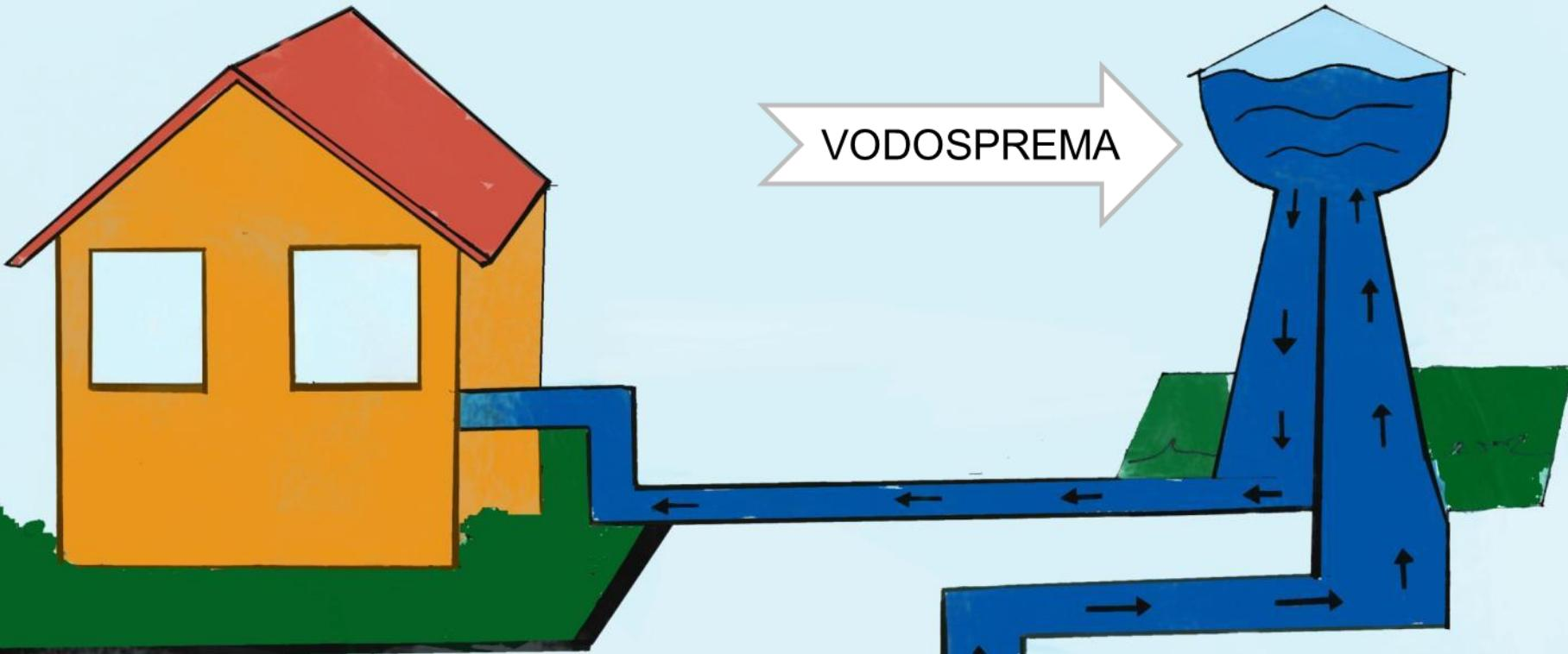
Iz zdenaca se voda crpkama odvodi u vodospreme. Voda se u cijevima klorira. Tako ona postaje dobra za piće.
